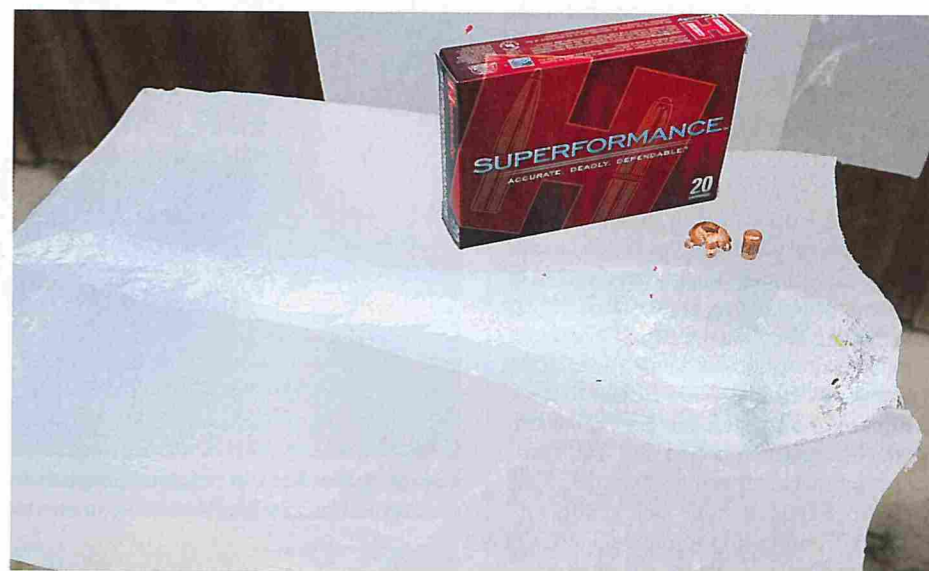
Hornady Superformance GMX: Das Deformationsgeschoss teilte sich in zwei Teile. Von allen fünf Bleifreien des Tests schlug es die längste Wundkaverne in die Ballistische Seife.
