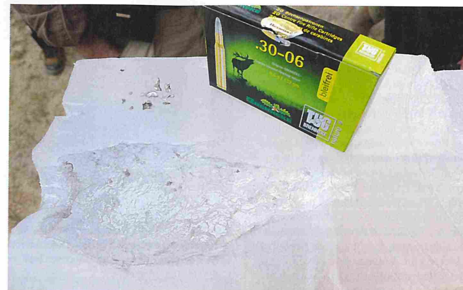
Brenneke TUG nature: Das Zerlegungsgeschoss splitterte völlig auseinander, das Restgewicht war zu vernachlässigen. Wegen vieler Löcher war das Volumen der Kaverne nicht messbar.
