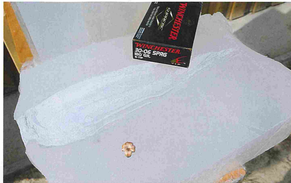
Winchester Nosler E-Tip: Das Deformationsgeschoss pilzte auf, wie's besser nicht sein könnte. Von den messbaren Wundkavernen war seine die größte. Leider war das Geschoss instabil.
